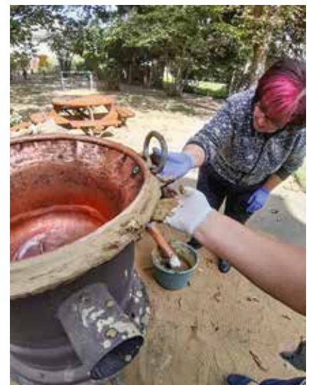
A rézüst beállítása, kikapasztása agyagos földdel, kavarószerkezet behelyezése
